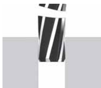
Развертка закусывается и ломается
