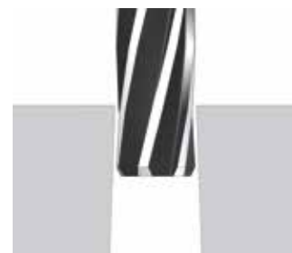
Коническое отверстие (на выходе слишком большое)
