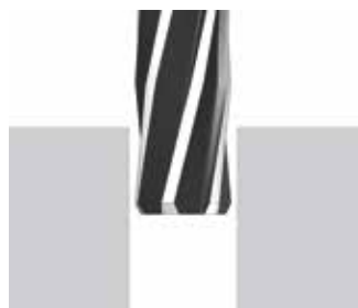
Отверстие становится слишком большим
