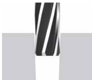
Коническое отверстие (на входе слишком большое)
