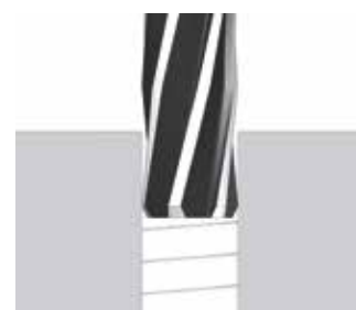
В отверстиях остаются неровности или заусенцы
