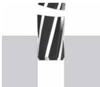
리머 걸림 및 파손
